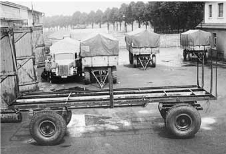
Eigenbau – Anhängerfahrgestelle in Leichtbauweise
